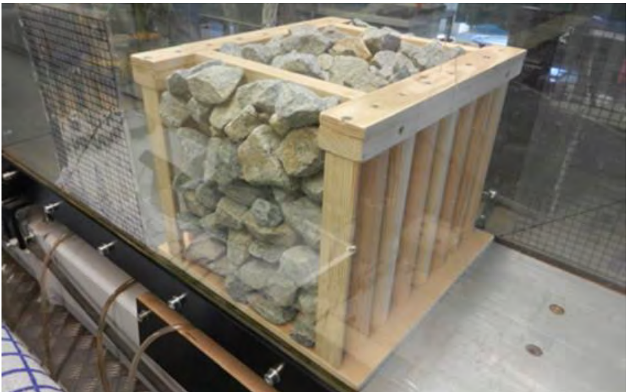
Hình 37. Mô hình vật lý cho công trình phá sóng kết cấu trụ bê tông đá đổ bên trong (như được sử dụng ở Cà Mau phía biển Tây) trong bể chứa của Đại học Kỹ thuật Hamburg-Harburg, Đức (TUHH). Hệ thống công trình phá sóng Cà Mau được mô phỏng với tỷ lệ 1:10 trong phòng thí nghiệm và thủy động lực được biểu diễn theo tỷ lệ chính xác với hệ thống thực tế. Hệ số truyền sóng và các thông số khác có thể được xác định và kết hợp với các nghiên cứu thực địa về bồi lắng trầm tích và dẫn đến khuyến nghị thực hiện một số sửa đổi.
