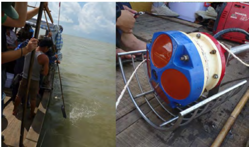
Hình 6. Lấy mẫu trầm tích (ảnh trái) và đo đạc dòng chảy và chế độ sóng với thiết bị ADCP (Acoustic Doppler Current Profiler, ảnh bên phải) ở Biển Tây và Biển Đông, tỉnh Cà Mau.
