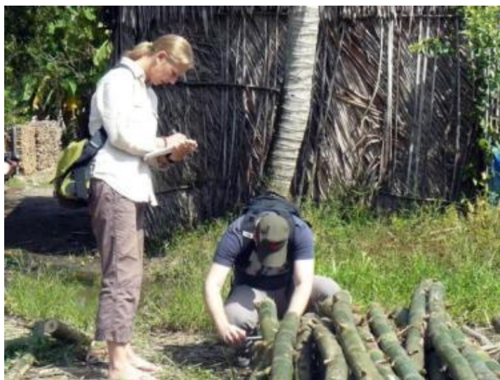
Hình 31: Kiểm tra đường kính các cọc tre
