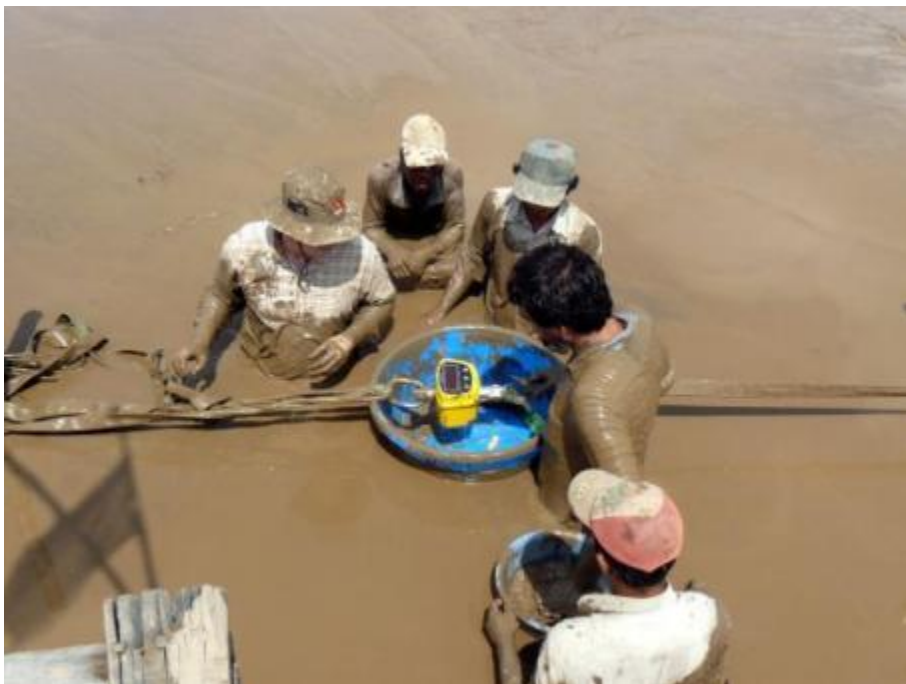
Hình 36: Máy đo trọng lượng tiêu chuẩn dạng cần cầu được sử dụng làm đồng hồ đo lực
