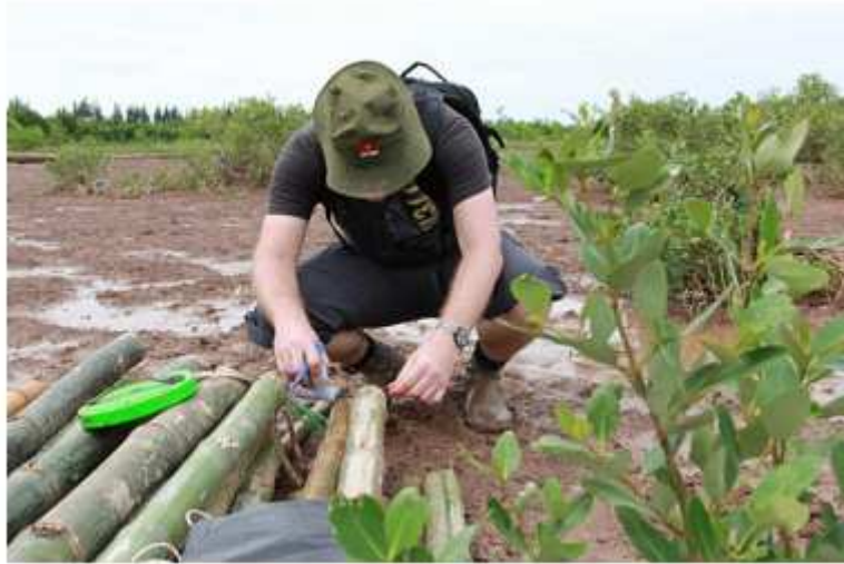
Hình 5: Đo đường kính của cọc tre dùng làm hàng rào
