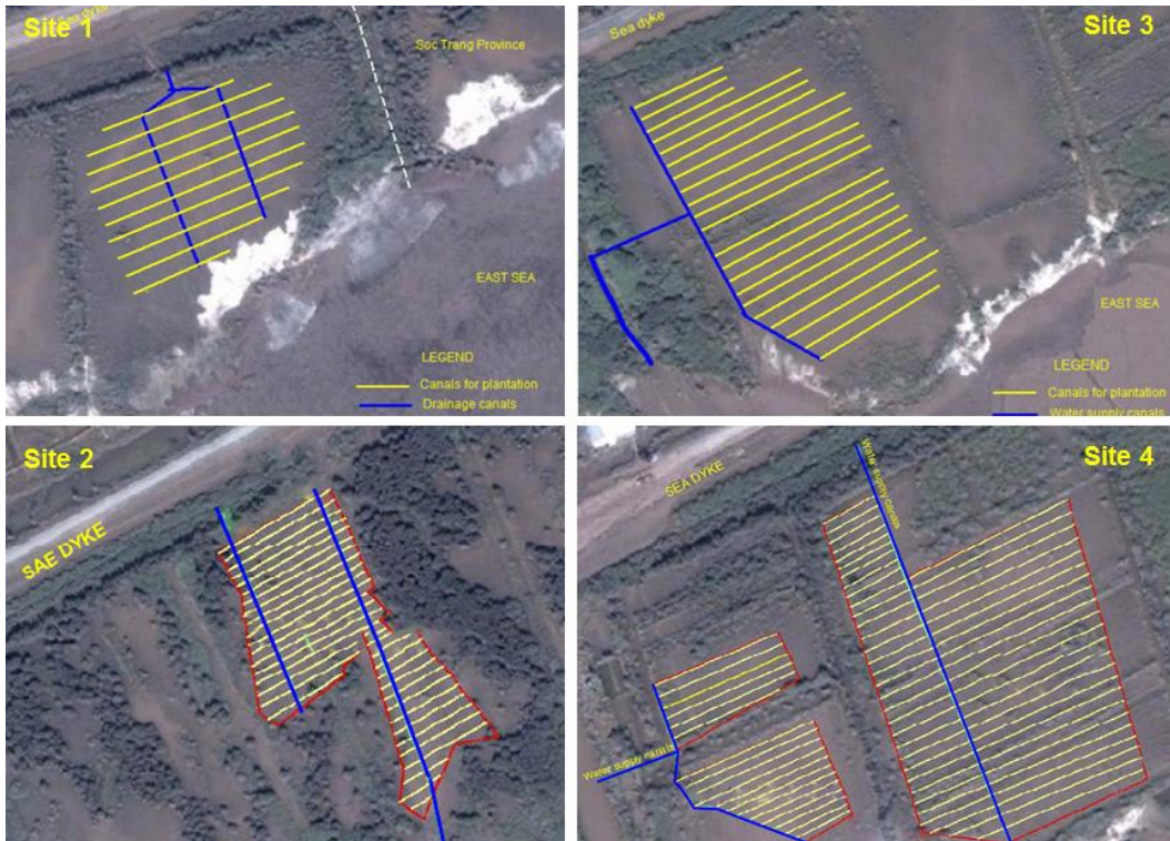
Hình 2: Vị trí, thiết kế và sơ đồ kênh mương, bờ líp tại các điểm trồng rừng
