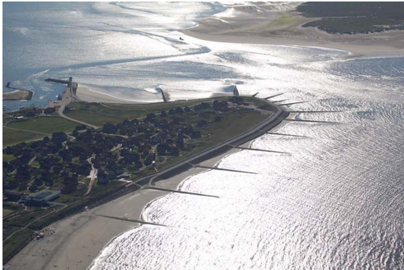
Abb. 8-5: Westkopf von Baltrum mit Deckwerken und Buhnen
