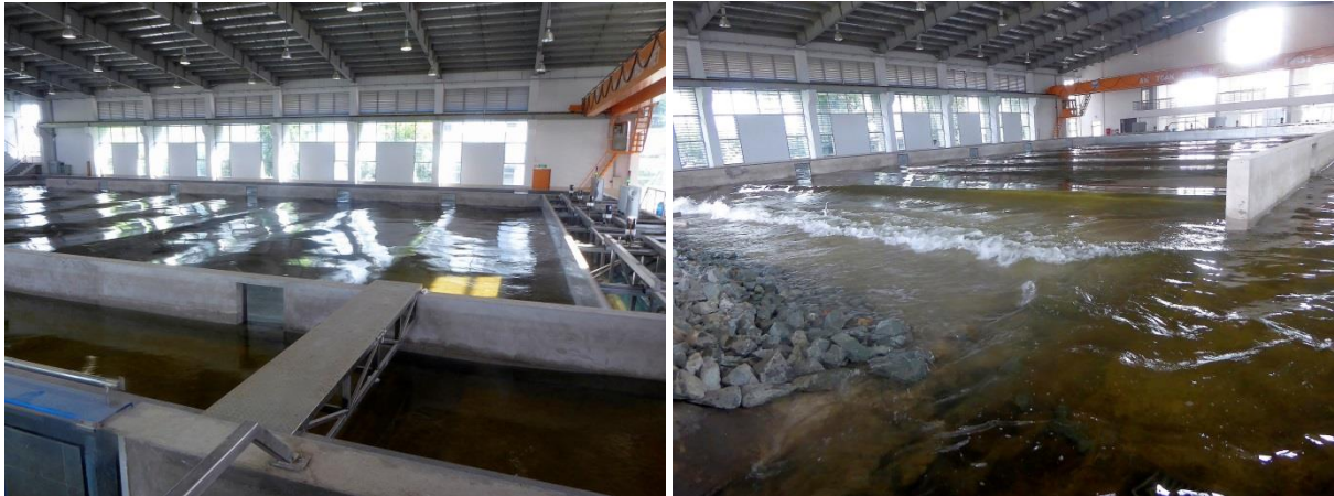
Hình 19a và 19b: Bể sóng nhân tạo tại phòng thí nghiệm của Viện KHTLMN với máy tạo sóng và cấu trúc hấp thụ sóng bằng đá tảng (Hình: Thorenz)
