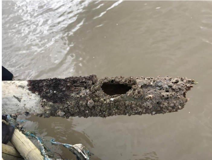
Hình 12: Cọc tre bị con hà ăn hỏng. Con hà ấu trùng bám lên bề mặt gỗ (tất cả các loại gỗ), đục và ăn sâu vào gỗ trong quá trình phát triển của nó. Các con hà khi lớn sẽ không gây hại và đục vào gỗ.
